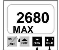
Wenn die Taraanzeige eingeschaltet ist, erscheint beim Drücken des Tasters „PEAK“ auf der Anzeige "MAXT" und der Spitzenwert des Gewichts wird angegeben – wobei weiterhin der Tarawert angezeigt wird.
