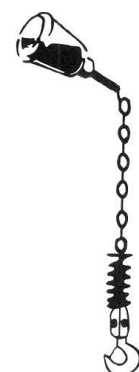
Afb. 42. Smeer de lastketting over zijn hele lengte.
