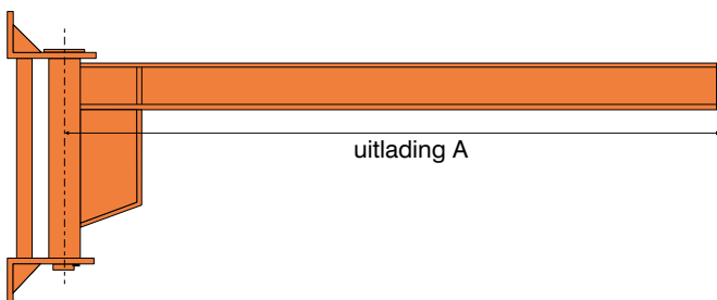
Type: Wandzwenkkrans met bovengebouwde ligger 180° draaibaar
