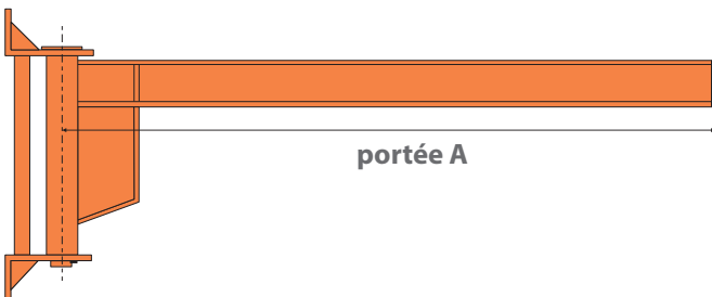
Type: Potence murale inversé en poutre "I" rotation manuelle 180 °
