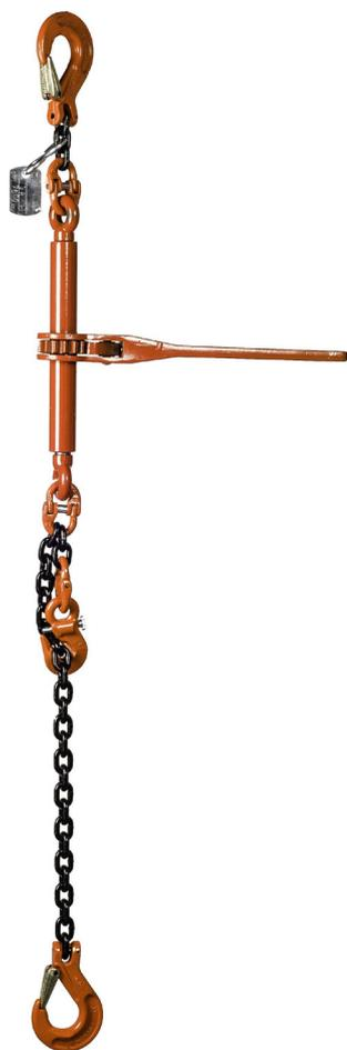
Les chaînes d'arrimages sont conçues pour arrimer les charges lourdes en toute sécurité pendant le transport routier, par avion et sur mer. Ils sont livrés avec tendeur à cliquet, crochet à linguet et crochet de réglage avec une axe de sécurité ce qui évite le détachement en tremblant des chaînes suite à une chute de tension provoquée pendant le transport. À l'aide du cliquet fourni, les chaînes d'arrimages peuvent être tendues d'une manière contrôlée.
