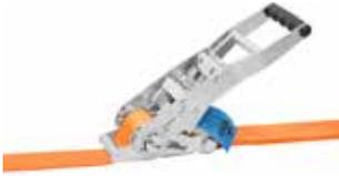
Le tendeur à cliquet EBC est un tendeur très sûr, car il permet de contrôler la tension de la sangle d'arrimage par étapes lors du lâchement des charges, ce qui permet d'éviter les situations dangereuses (les tendeurs à cliquets standard permettent qu'un relâchement de la tension en une seule fois). Le crantage à chaque côté du tendeur à cliquet donne automatiquement une pré-tension supérieure Stf 450 daN.
