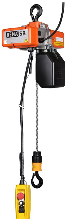
Le palan électrique à chaîne REMA type SR 230 V est un palan modulaire et moderne, son avantage est le facteur de marche important. Pour le branchement à une phase, il faut utiliser un câble d'une section minimale de 2.5 mm<sup>2</sup>. Pour l'alimentation au courant sur chantier, il faut utiliser un câble aussi court possible, pour minimiser la baisse de tension.
