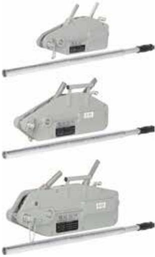
Le Gripper est un treuil à câble passant très robuste, utilisable en toute position, capacités de charge de 800 kg, 1600 kg et 3200 kg. Le mouflage permet de doubler toutes ses charges. Les goupilles de sécurité et le levier sont des indicateurs fiables en cas de surcharge.
