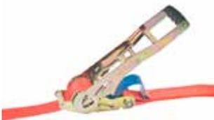
Le tendeur à cliquet ou ratchet ERGO (levier long) tendu par un mouvement de traction, permet de réaliser un plus grand effort de force (les systèmes standard sont avec un cliquet à poussée). Grâce à la force de pré-tension élevée Stf de 500 daN, moins de sangles d'arrimage sont nécessaires pour arrimer une même charge.
