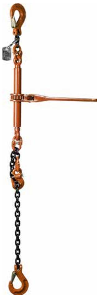
Les chaînes d'arrimages sont conçues pour arrimer les charges lourdes en toute sécurité pendant le transport routier, par avion et sur mer. Ils sont livrés avec tendeur à cliquet, crochet à linguet et crochet de réglage avec une axe de sécurité ce qui évite le détachement en tremblant des chaînes suite à une chute de tension provoquée pendant le transport. A l'aide du cliquet fourni, les chaînes d'arrimages peuvent être tendus d'une manière contrôlée.
