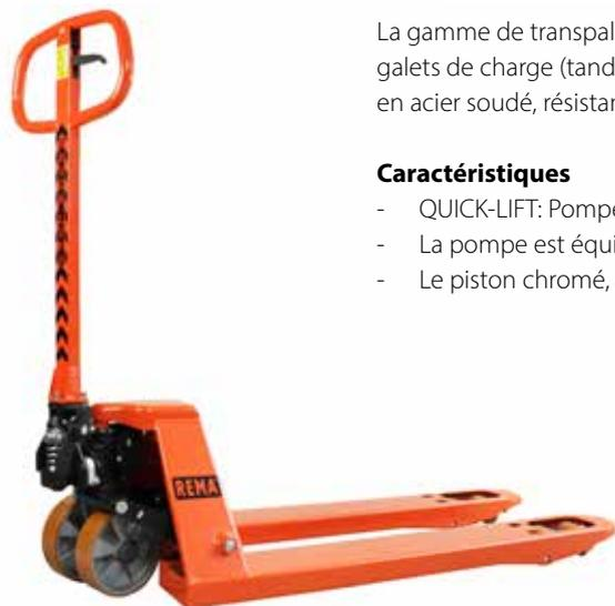
La gamme de transpalettes type PT à pompe "quick-lift" (les modèles 25). Maniable et ergonomique. Les galets de charge (tandem ou simple) sont en polyuréthane (silencieux) ou en nylon. Equipé de fourches en acier soudé, résistant aux torsions.
