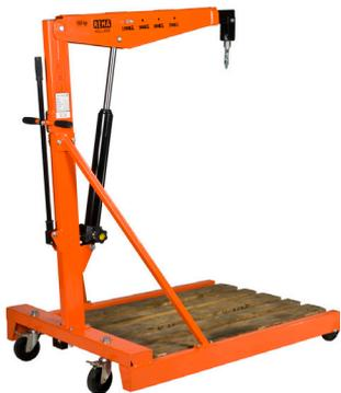
Der REMA Werkstattkran GWKE ist ein mobiler, sicherer und robuster Werkstatt- und Montagekran. Durch das breite Fahrgestell kann eine Europalette oder Gitterboxen umfahren werden.
