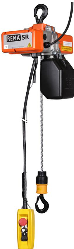
Der REMA SR 230V/24V Elektrokettenzug ist für unterschiedliche Traglasten lieferbar und besitzt dieselben Vorteile wie die Standardzüge für 400V ( Sicherheits-Rutschkupplung, Bremsbaugruppe, niedrige Bauhöhe usw.). Für den Einphasen-Netzanschluss ist ein Leitungsquerschnitt von mindestens 2,5 mm<sup>2</sup> zu verlegen. Im Fall eines bauseitigen Stromverteilers sollte der Netzanschlusskabel wegen dem Spannungsabfall so kurz wie möglich gehalten werden.
