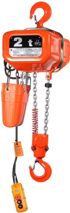
Die Elektro-Kettenzüge 400 V sind stark und solide ausgeführt und haben ein robustes Gehäuse aus Stahlblech. Sehr beliebt durch die komplette Ausführung mit Endschaltern, 24V Steuerspannung und Steckerverbindungen. Hohe Einschaltdauer und die hohe Hubgeschwindigkeit sorgen für eine problemlose Funktion und eine lange Lebensdauer.
