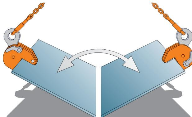
**REMA Universal-Hebeklemmen CU bis zu einer Härte von 37 RC (345 HB)**
