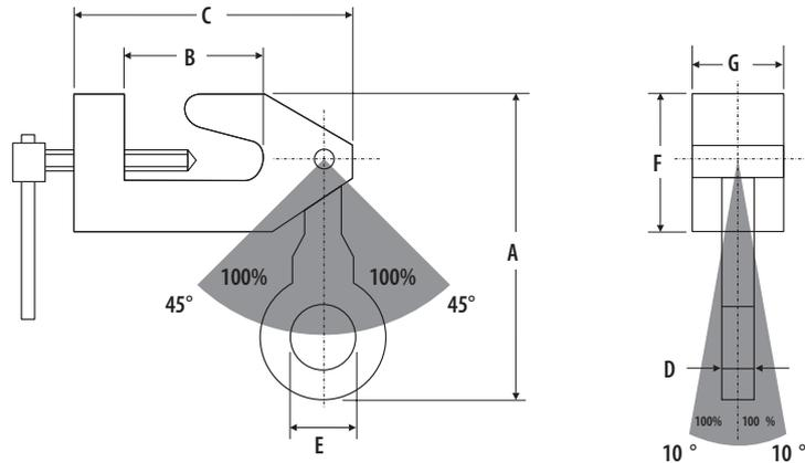
**Sichere Arbeitsbelastung bei Verwendung verschiedener Winkel**
