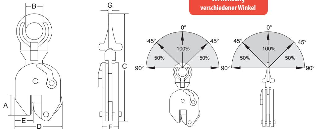
**Sichere Arbeitsbelastung bei Verwendung verschiedener Winkel**
