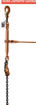
Die REMA Zurrketten dienen der sicheren Befestigung von schweren Lasten während des Transports per Lkw, Eisenbahn, Flugzeug oder Schiff. Die Zurrketten sind mit Ratschenspannelement, Lasthaken mit Hakensicherung und Verkürzungshaken ausgerüstet, welche das Auflockern der Zurrkette während des Transports verhindert. Mit der Ratsche kann die Zurrkette kontrolliert gespannt werden.
