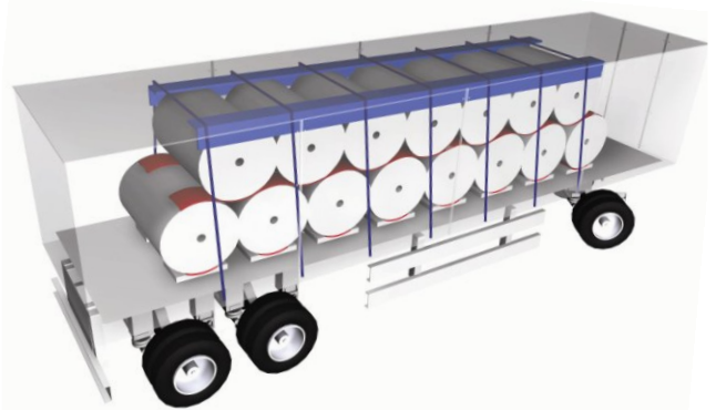
Niederzurren mit Gebrauch von Anti-Rutsch-Matten (Rot) und Kantenschutzmitteln (Blau).
